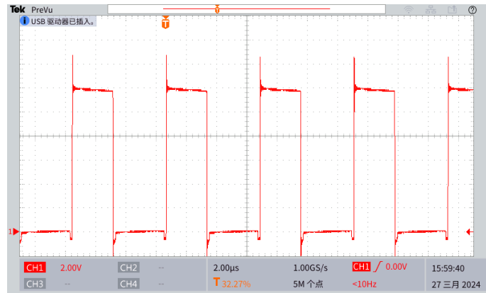
图 1.常见的降压转换器的开关波形
