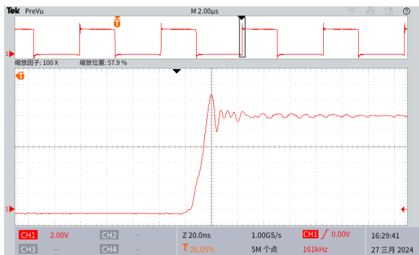
图 8.无 C1 电容时开关上升沿波形
