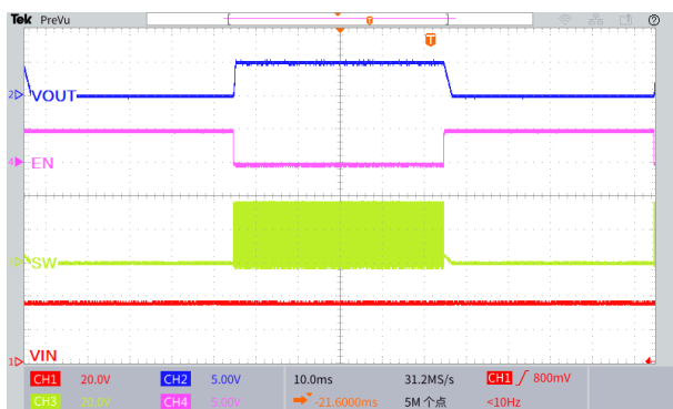
图 34.EN 引脚开关机波形 ( V_{IN}=36V , V_{OUT}=5.0V , I_{OUT}=0.5A )
