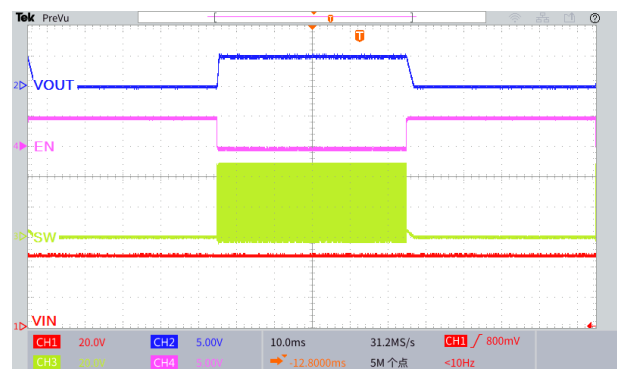
图 35.EN 引脚开关机波形 ( V_{IN}=48V , V_{OUT}=5.0V , I_{OUT}=0.5A )
